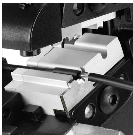
ściągnięcie izolacji kabli oraz...
