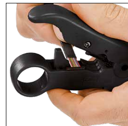
Ściąganie izolacji z kabla taśmowego.
